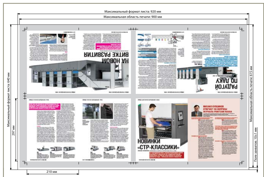
Чертеж восьмистраничного спуска издания формата A4, укладывается на лист печатной машины Ryobi 920 идеально
