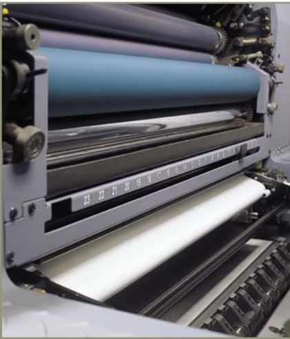
Устройство автоматической смывки офсетного полотна
