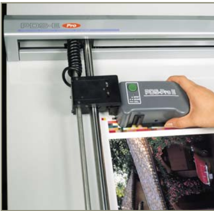
Устройство контроля оптической плотности краски PDS-Pro E
