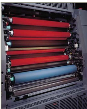
Схема и внешний вид красочного и увлажняющего аппаратов машины Ryobi 920
